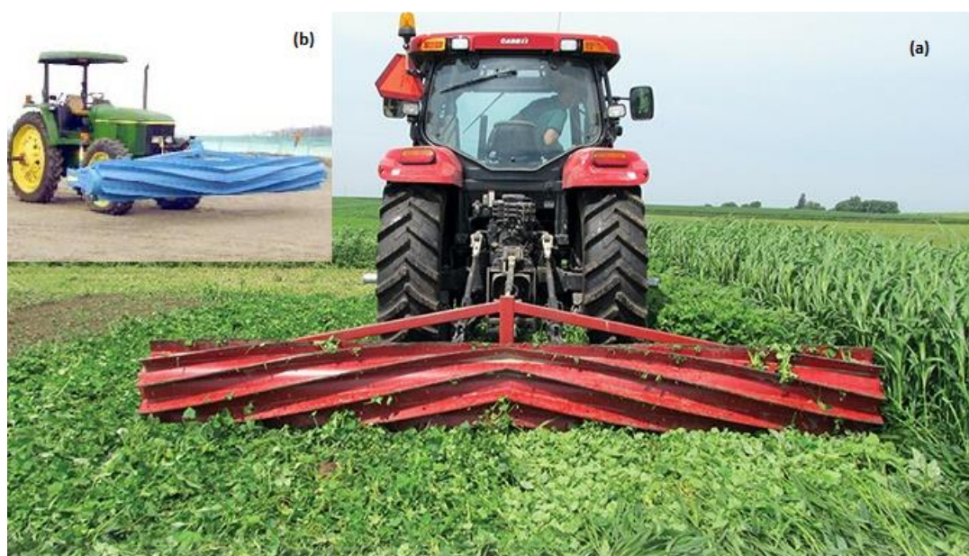
Figura 6: Rolo acondicionador de rastrojos y coberturas. (Roller crimper). Colocado como herramienta de tiro (a) o frontal (b).
