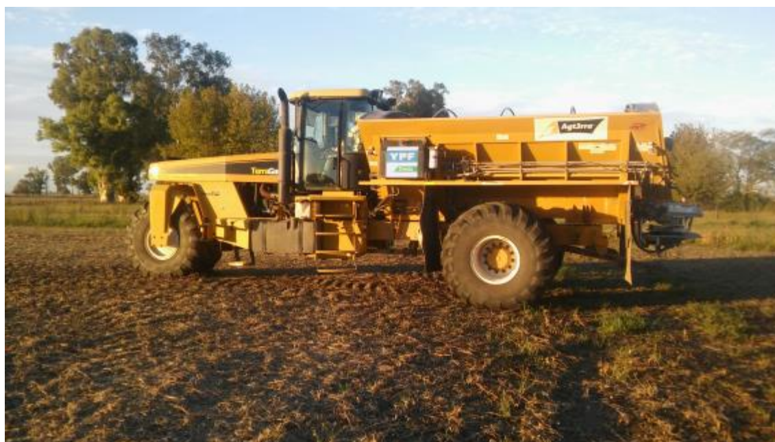
Figura 2. Moderno aplicador de fertilizantes con posibilidad de variación de dosis en tiempo real según prescripción previa.
