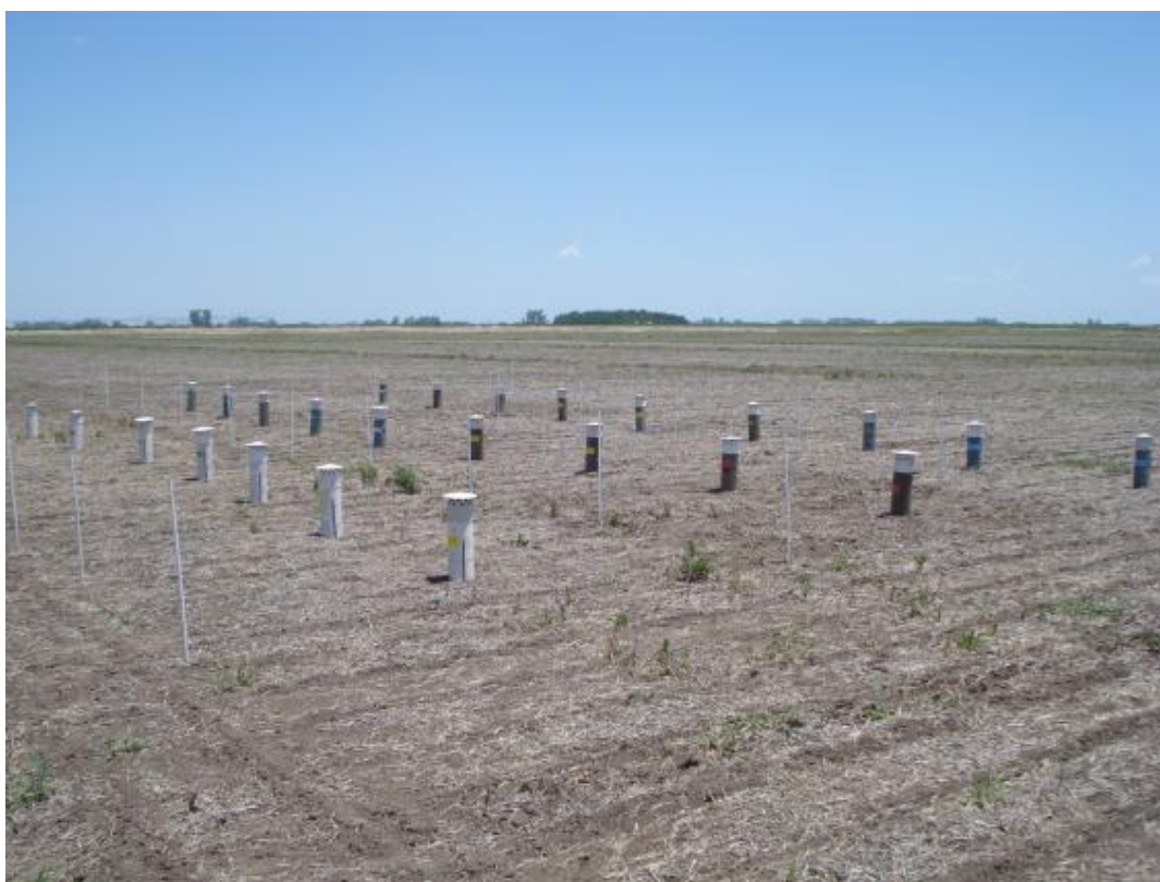
Figura 4. Trampas de amonio para cuantificar volatilización de nitrógeno. El proceso puede evitarse mediante la correcta elección de la fuente, o la incorporación de los fertilizantes.
