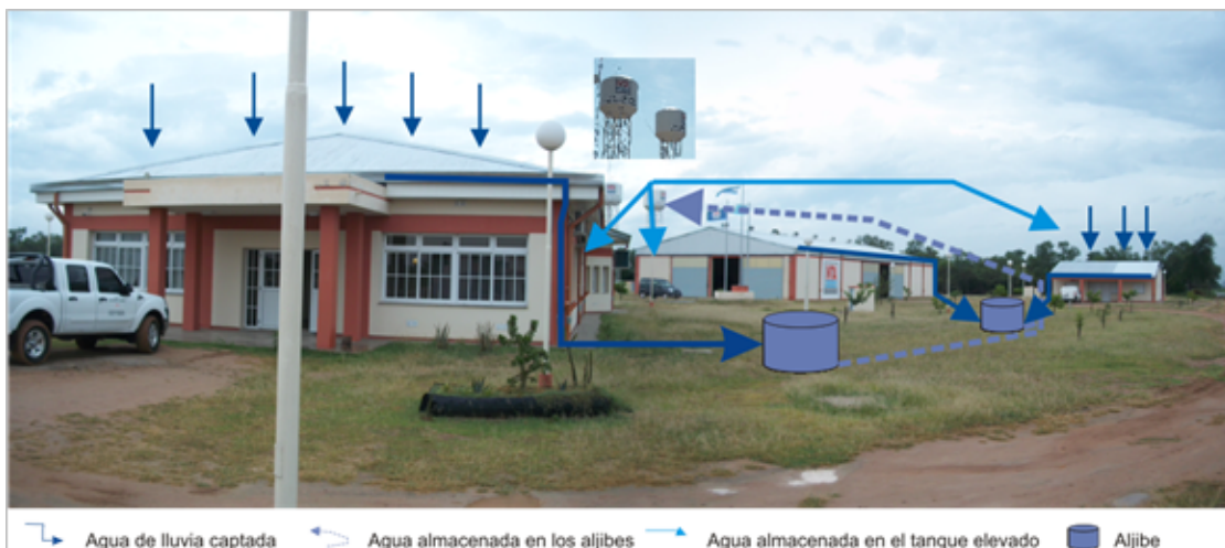
Ilustración 6. Detalle del Sistema de Cosecha de Agua de Lluvia utilizando los techos de los edificios de la EEA Ingeniero Juárez, como superficie de captación.
